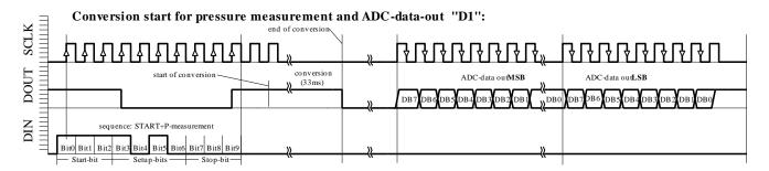
Fig. 6a: D1 ACQUISITION sequence
